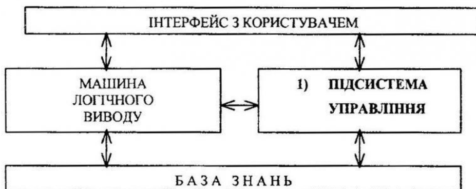
Рис. 1. Структура експертної системи "ТехноЕксперт"
